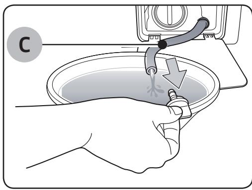
4. Откройте колпачок трубки и позвольте воде в **трубке** (C) вытечь в этот сосуд.
