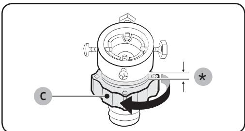
3. Возмитесь за адаптер и поверните его часть (C) в указанном стрелкой направлении, вывинтив его на 5 мм (\*).
