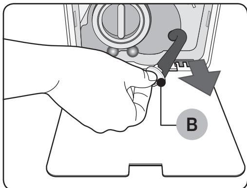
3. Положите пустой, вместительный сосуд на крышку и протяните аварийную дренажную трубку в этот сосуд, удерживая **колпачок трубки** (B).
